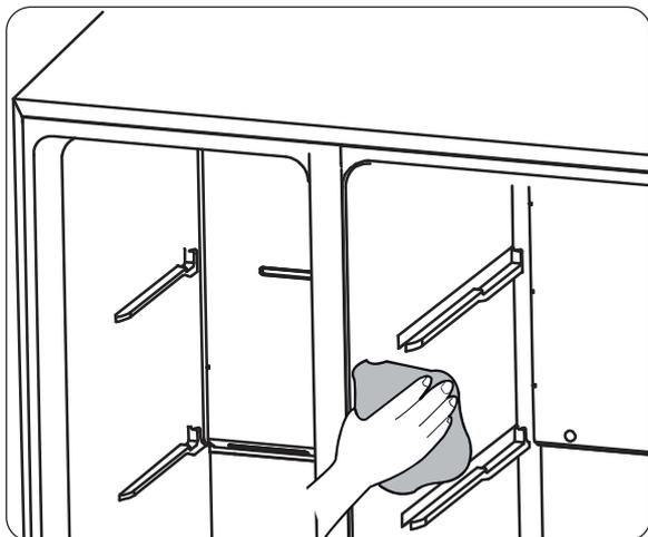
Bien que cet appareil se dégivre automatiquement, une couche de givre peut se produire sur les murs à l'intérieur du compartiment du congélateur si la porte du congélateur est ouverte fréquemment ou reste ouverte pendant longtemps. Si le gel est trop épais, choisissez un moment où le congélateur est presque vide et procédez comme suit:
