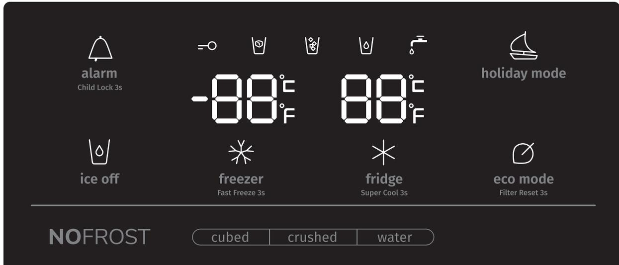
Lorsque l'appareil est allumé pour la première fois, le rétro-éclairage des icônes sur le panneau d'affichage s'allument. Si aucune touche n'a été appuyée et que les portes sont fermées, le rétro-éclairage s'éteint après 60 secondes.
