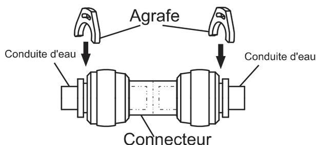
Ouvrez le robinet d'eau pour rincer les conduites, et vérifiez s'il y a des fuites au niveau des connecteurs de l'eau. S'il en existe, veuillez-vous rassurer que les conduites sont complètement insérées à l'endroit où il y a une fuite. S'ils n'étaient pas bien insérées, veuillez reprendre l'installation à nouveau, et rassurez-vous que les conduites sont bien insérés cette fois-ci.
