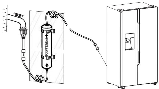
Les conduites d'eau ne doivent pas être compressées par des choses lourdes et ne doivent pas être trop pliées.
