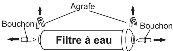
Deuxièmement, insérer complètement les conduites d'eau dans l'entrée et la sortie du filtre à eau.
